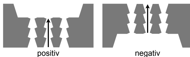
Abbildung 4.3: Definition von Membranorientierung und Driftstrom: Teilchen, die in positive Richtung transportiert werden, erscheint die Pore als eine Reihe von Trichtern. Die Definition folgt [Ket00] und [Mat02].
